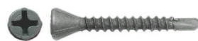
Vis pour plaque de fermacell, PH2, petite tête plate, gris phosphaté, pointe autoforeuse
