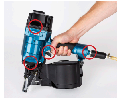
Prüfung auf Luftverlust und Undichtigkeiten
