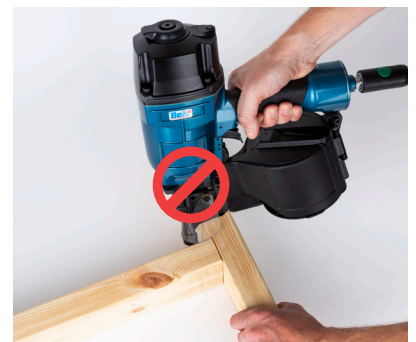
Gerät niemals als „Hammer“ verwenden
