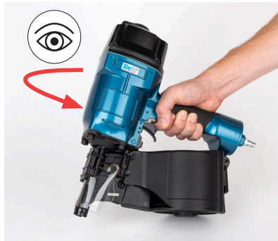
Sichtkontrolle auf Beschädigungen
